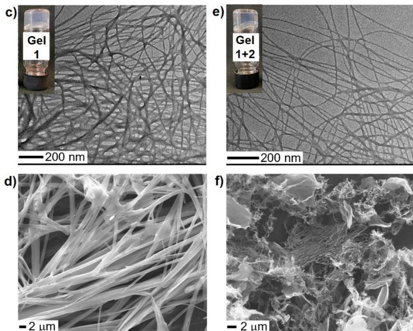
c-e) Immagini ottenute tramite due diverse tecniche di microscopia elettronica del network di fibre che caratterizza gli idrogeli dell'amminoacido Fmoc-pentafluoro-fenilalanina da solo (c-d) e insieme alla molecola partner (e-f). Insetti: fotografie dei due idrogeli.
