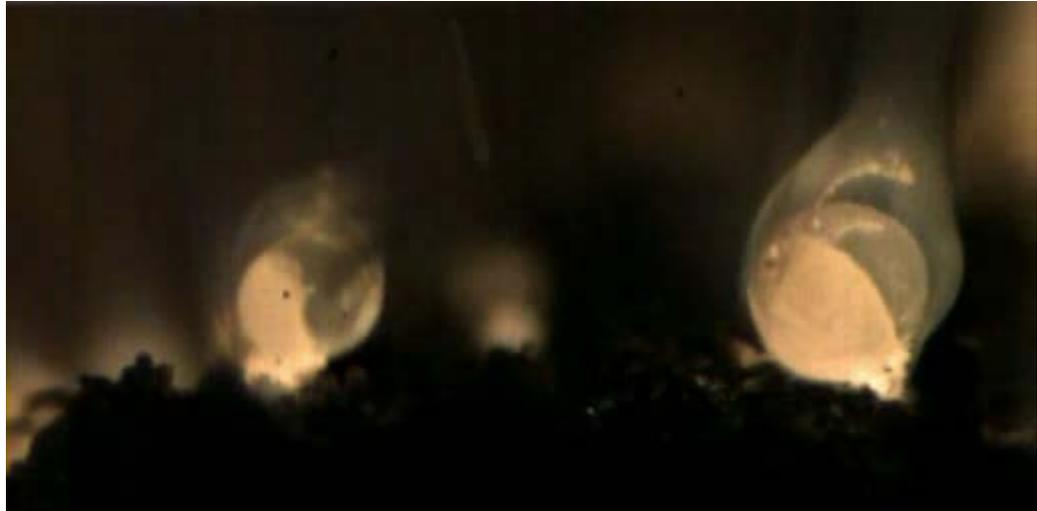
*Figura 1: La combustione del metallo nel propellente solido. Gocce di metallo fuso, detti agglomerati, sporgono sulla superficie del propellente. (SPLab-POLIMI)*
