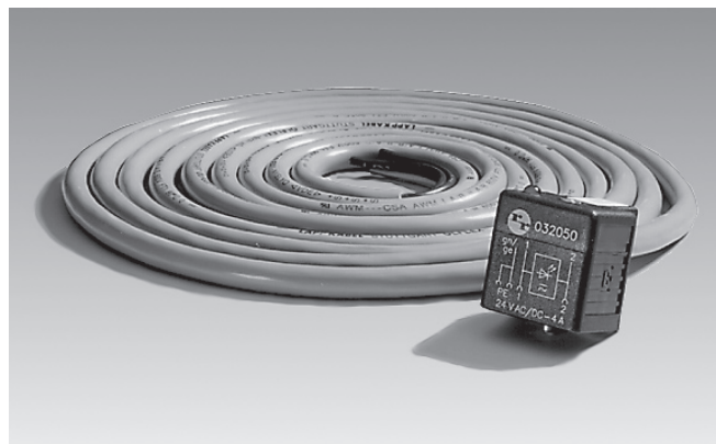
Connettori secondo DIN EN 175 301-803 e ISO 4400, 2 poli + T, con cavo saldato, per elettrovalvole con presa "K4"
