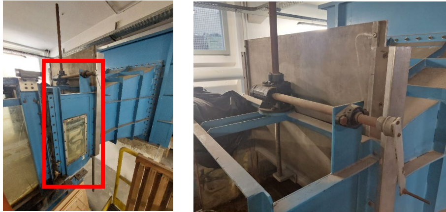
Figura A.5.1 a sinistra il tratto metallico evidenziato in rosso, a destra la paratoia al suo interno
