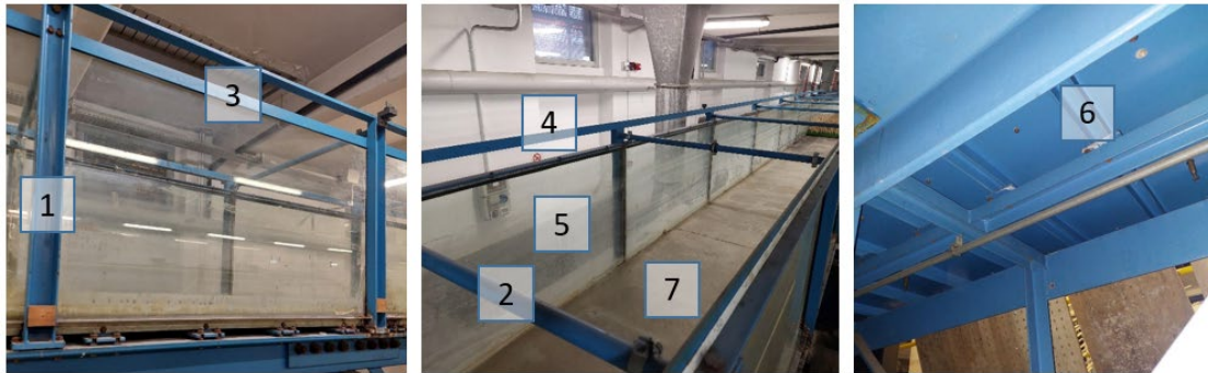
Figura A.1.1 elementi che compongono il concio del canale
