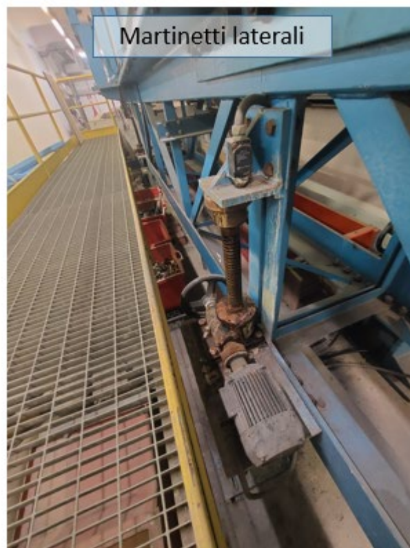
Figura A.4.1 martinetti principali (numero 2) e laterali (numero 10)
