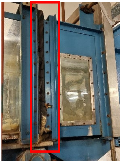
Figura A.6.1 giunto di dilatazione
