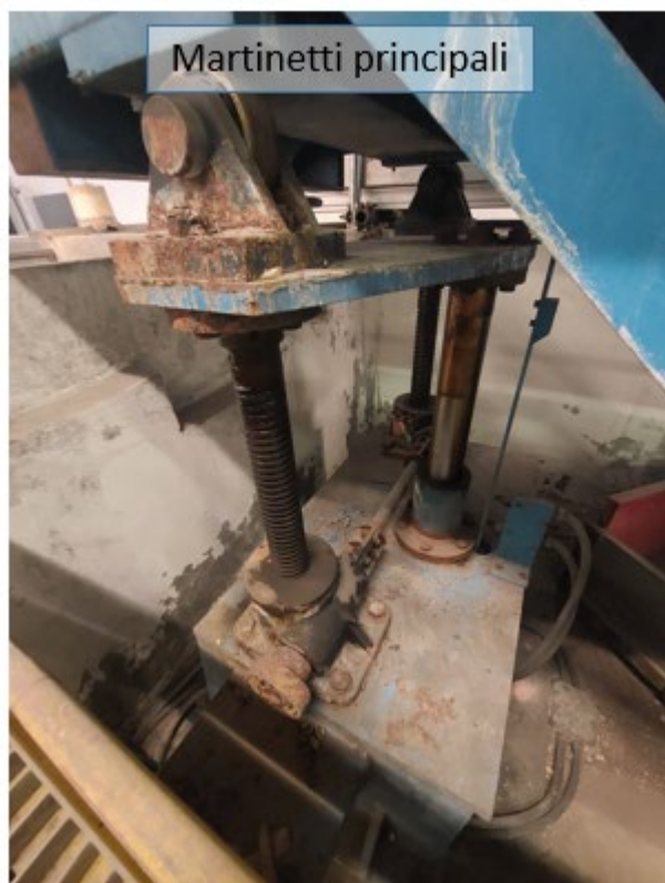
Figura A.4.1 martinetti principali (numero 2) e laterali (numero 10)
