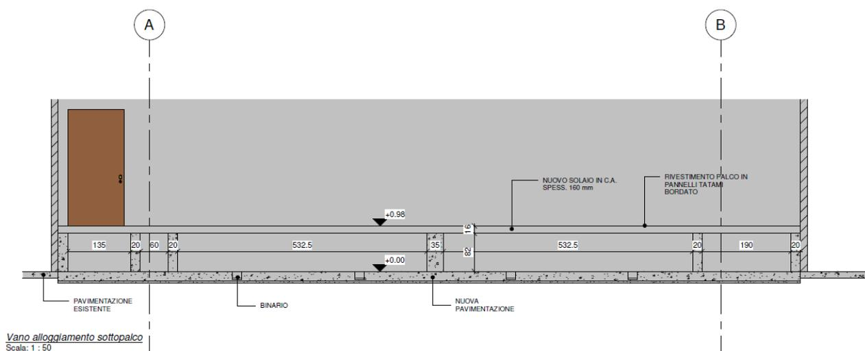
2. Realizzazione di una nuova platea in CA con una portata massima di 2500 kg/mq nella quale sono state predisposte le sedi di alloggiamento dei 4 binari che con apposite guide di traslazione consentiranno la movimentazione delle file in fase di apertura/compattamento.
