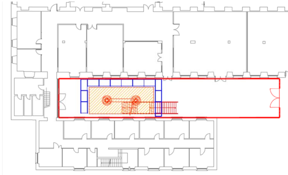
Scala 4 – area cantiere con posizionamento ponteggio
