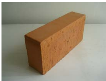
Figura .1 - Esempio di mattone pieno \phi \leq 15\% in laterizio per murature portanti 2
