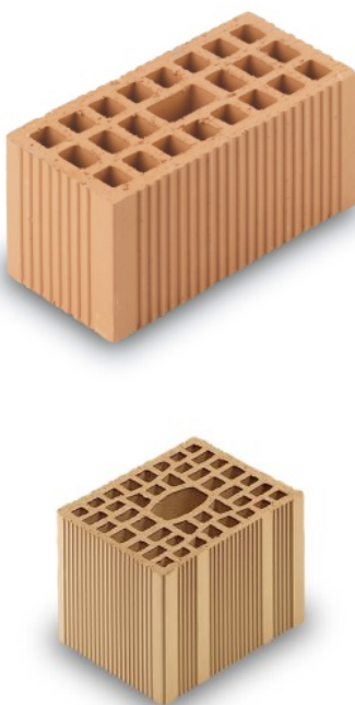
Figura .2 - Esempio di mattone semipieno 15\% < \phi \leq 45\% in laterizio per murature portanti 3
